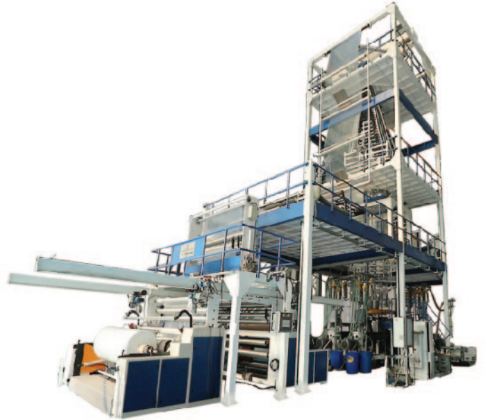
Magnate Yedi Katlı Blown Film Makinesi 1250-2500 mm eninde 170-400 kg/saat kapasiteli
